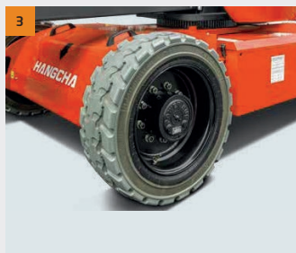
Pneus: pneus superelásticos com bom desempenho off-road
